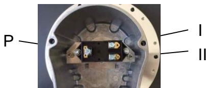
Elektrische Kontakte bei unbelasteter Membran:
