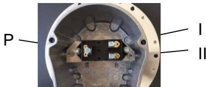
Elektrische Kontakte bei unbelasteter Membran:
